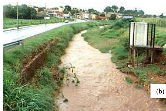
Figura 4- Escoamento no trecho de montante para y < y_{cb} (a) e y > y_{cb} (b) em uma seção de controle da bacia do Gregório (área de drenagem = 10,1 km 2 ). Fonte: FINEP/FIPAI-EESC/DAEE (2003) www.busplanodiretor.hpg.com.br
